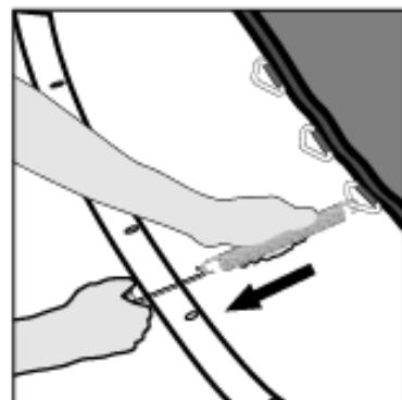
и тяните пружины при помощи инструмента для натягивания до тех пор, пока пружина не дотянется до отверстия на раме батута, а затем отсоедините инструмент от пружины.
