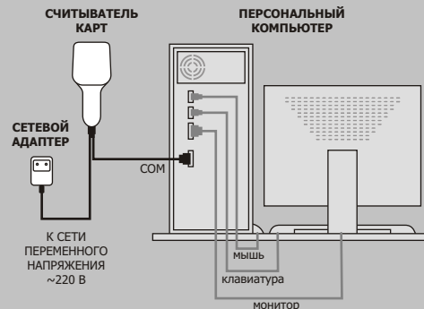
РИСУНОК 4 СХЕМЫ ПОДКЛЮЧЕНИЯ СЧИТЫВАТЕЛЯ КАРТ
