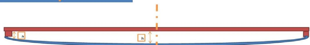
*Mesure la distance mini et la distance maxi entre la règle et le panneau*
